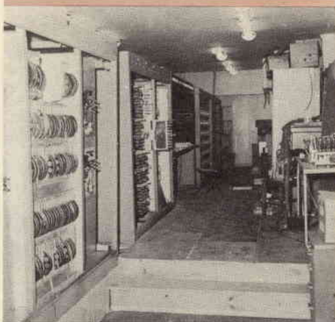
La calcolatrice elettronica Univac 1103, formata da due file di armadietti come questi, occupa quasi tutto il negozio del suo proprietario.
